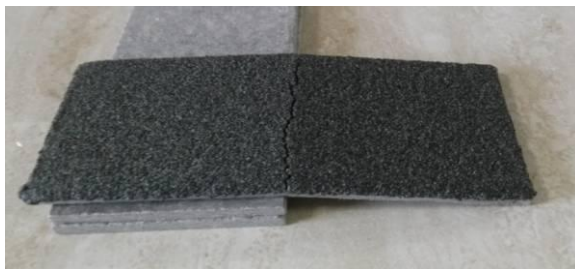
顺缝隙处弯折至石棉板折断
