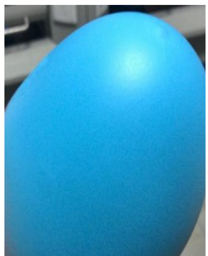
挤压1000次后漆膜细节
