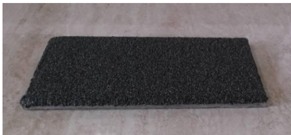
背面切有浅缝真石漆石棉板
