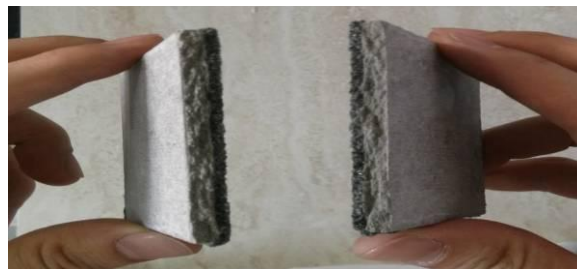
石棉板断裂观察漆膜抗开裂能力
